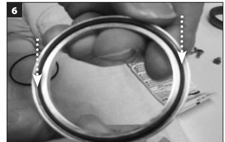
**Для уплотнений с набором втулок.** Нанесите тонкий слой **белой** консистентной смазки на уплотнительное кольцо (Y) и установите его в канавку на бронзовой втулке. **ВАЖНАЯ ИНФОРМАЦИЯ. Убедитесь в том, что уплотнительное кольцо полностью установлено и полностью зафиксировано в канавке уплотнительного кольца. Уплотнительное кольцо может представлять слишком большим при установке и его необходимо вдавить.**
