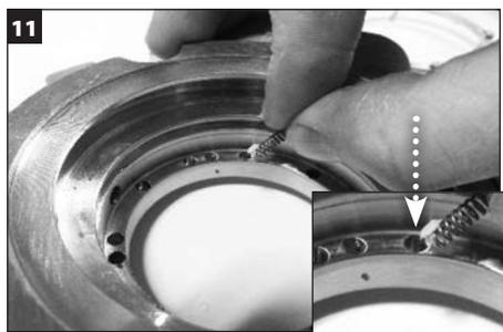
Окуните концы пружин в белую консистентную смазку и вставьте в каждое отверстие для пружины. **ВАЖНАЯ ИНФОРМАЦИЯ. НЕ вставляйте пружины в четыре (два) равномерно расположенных отверстия, отмеченных углублениями и предварительно заполненных консистентной смазкой 635 SXC.**
