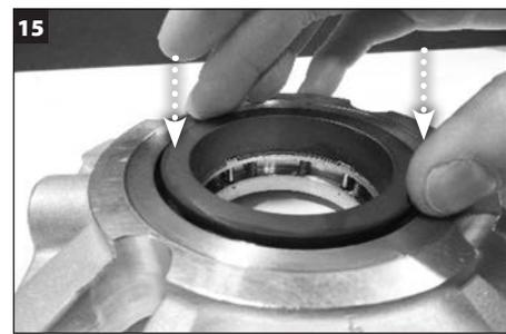
Совместите пазы на неподвижной уплотнительной поверхности с поводками на пластине толкателя и осторожно вдавите уплотнительную поверхность вниз, пока она не будет полностью установлена. **ПРЕДОСТЕРЕЖЕНИЕ. Неправильное совмещение приведет к появлению сколов на краях пазов уплотнительной поверхности.** Очистите неподвижную уплотнительную поверхность безворсовой тканью и утвержденным чистящим растворителем, соответствующим местным и заводским нормам.
