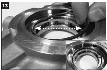
Нанесите тонкий слой **белой** консистентной смазки на неподвижное уплотнительное кольцо (X) и установите его в канавку в сальнике над узлом пластины толкателя.
