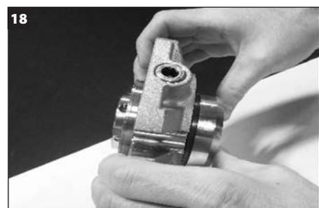
Поднимите сальник и удерживайте нижнюю часть втулки, чтобы перевернуть ее, и осторожно установите, чтобы обеспечить контакт между неподвижной и вращающейся уплотнительными поверхностями.
