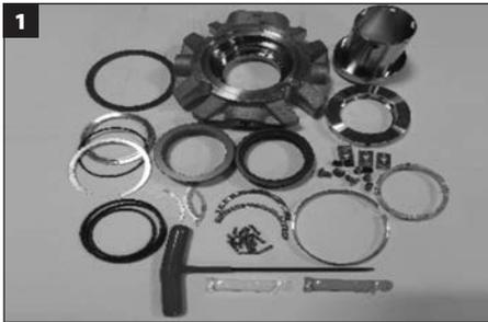
Инструменты, необходимые для установки уплотнения. Шестигранный ключ и два вида консистентной смазки (поставляются с уплотнением); безворсовая ткань, пинцет или тонкий остроконечный инструмент (поставляются заказчиком; для установки уплотнительных колец и приводных труб). Очистите утвержденным растворителем все металлические компоненты, включая все поверхности прокладок и уплотнительных колец. Поместите металлические компоненты и все запасные компоненты уплотнения на чистую сухую поверхность.
