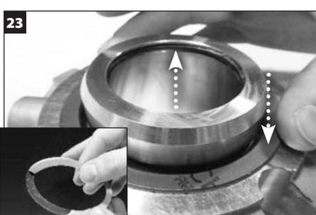
Нанесите тонкий слой **белой** консистентной смазки на уплотнительное кольцо (V) вала и установите его на втулку в канавку на внутреннем диаметре уплотнительного кольца. Снимите клейкую подложку с прокладки сальника и установите ее в углубление для прокладки сальника.
