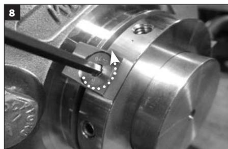
Удалите все винты с плоской головкой и центрирующие зажимы; сохраните их для использования при будущих регулировках рабочего колеса и/или удалении уплотнения.
