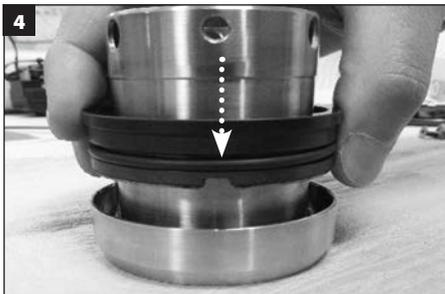
Совместите метку на вращающейся уплотнительной поверхности с вырезом на втулке. Сдвиньте вращающуюся уплотнительную поверхность вниз к втулке и аккуратно вдавите до ее установки. Поводки привода втулки должны зацепиться с пазами на вращающейся уплотнительной поверхности. **ПРЕДОСТЕРЕЖЕНИЕ. Не сжимайте приводную трубу.**
