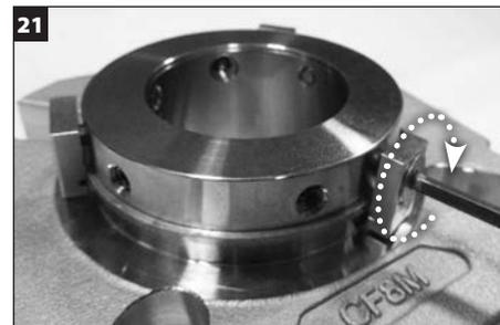
Установите центрирующие зажимы на наружный диаметр стопорного кольца с помощью винтов с плоской головкой центрирующего зажима.
