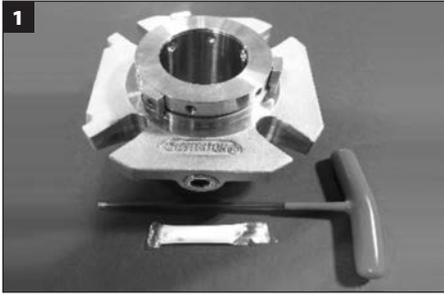
Инструменты, необходимые для установки. Шестигранный ключ и белая консистентная смазка (**поставляется с уплотнением**); ключ с открытым зевом или торцевой ключ (размер зависит от размера крепежного болта; **поставляется заказчиком**). **ВАЖНОЕ ПРИМЕЧАНИЕ.** Доступ к данным уплотнения можно получить с установленной метки RFID; вы также можете заполнить ссылку на справочные данные уплотнения на этикетке упаковки на титульной странице этих инструкций.
